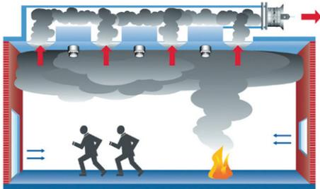
Bild 6: Maschinelle Rauchabzugsanlagen
