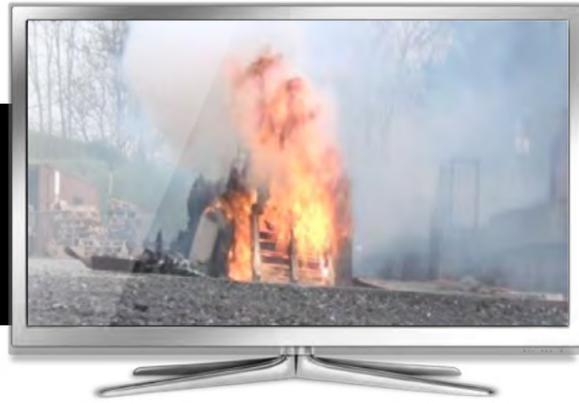
Das thermische Durchgehen (thermal runaway) einer LMP-Batterie äußert sich in sehr dichten Flammen mit beträchtlicher Rauchentwicklung und dem Wegspritzen fusionierter Metallpartikel.
