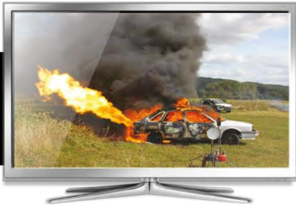
Wenn aus dem Fahrzeug im stehenden Zustand Treibstoff in gasförmiger Phase über das Sicherheitsventil austritt, führt das zu einer periodisch auftretenden Stichflamme. Wenn das Fahrzeug auf dem Dach liegend, Gas in flüssiger Phase über das Ventil austritt, führt das zu einer gleichmäßigen Stichflamme.
