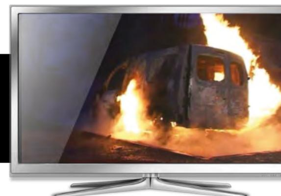
Die Überhitzung der Batterie setzt brennbares Gas frei. Die Flammen eines Hybrid- oder Elektrofahrzeugbrandes ähneln daher Gasflammen.
