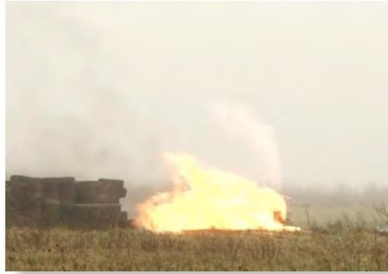
Eine doppelte Absicherung durch den Einbau von Thermo­sicherungen in LNG-Tanks ist derzeit nicht vorgeschrieben. Das Ventil könnte durch den Brand so stark beschädigt werden, dass es nicht mehr funktioniert, wodurch der Druck im Tank bis zum BLEVE-Risiko ansteigt.
