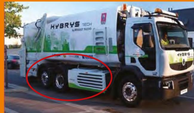
Das Batteriepaket wird in der Regel an den Flanken (Unterseite) des LKWs angebracht...
