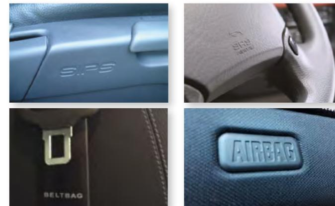
Die ungefähre Position eines Airbags im Fahrzeug kann je nach Modell durch die folgenden Kennzeichnungen ermittelt werden: **SRS AIRBAG, AIRBAG, SRP, SIPS BAG, SIR, HPS, IC, WC, RS...** oder durch ein Symbol auf dem Armaturenbrett oder auf der Windschutzscheibe.
