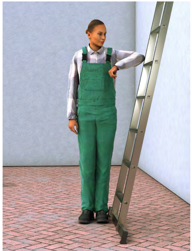
Abb. 59 „Ellbogenmethode“ zur Bestimmung des Anlegewinkels
