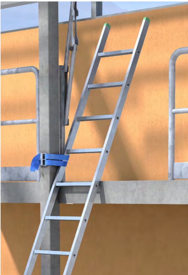
Abb. 1 gesicherte Leiter als Verkehrsweg mit 1 m Überstand
