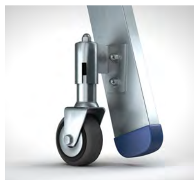
Abb. 63 Federbelastete Fahrrolle: „Automa- tische“ Sicherung durch die Belastung beim Betreten.
